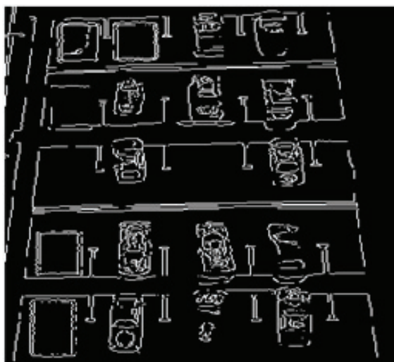
Figura 10. Modelo em escala reduzida da área de estacionamento após o processamento da imagem.
