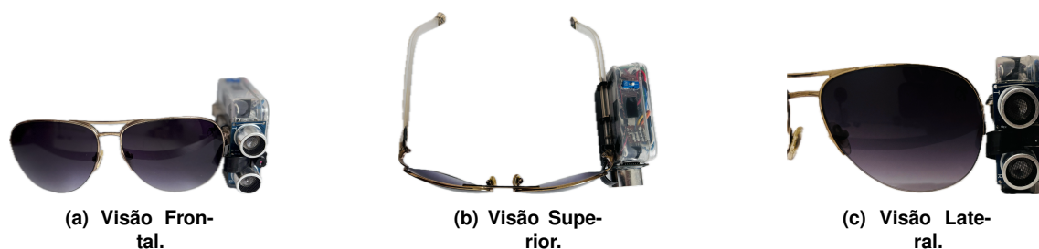
Figura 4. Diferentes ângulos de visão do dispositivo Áurea e disposição dos sensores.
