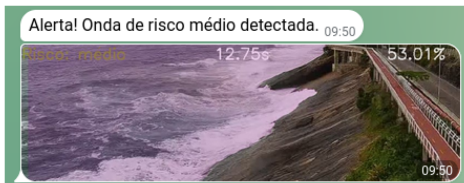
Figura 5. Exemplo de alerta do sistema desenvolvido, gerado por uma onda de risco médio. A imagem enviada consiste em uma captura de tela do sistema. Em roxo, está sobreposta a máscara de segmentação do modelo. No meio, a duração do evento de risco em segundos. O número à direita indica a altura da onda em porcentagem de encosta coberta.
