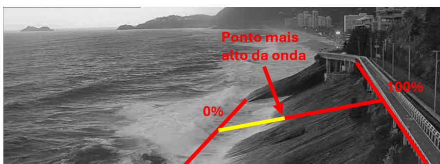
Figura 4. Exemplo de retas utilizadas durante o cálculo de altura da onda em função das curvas delimitadas.
