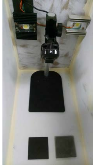
Figura 2. Ambiente controlado construído para captura de imagens.
