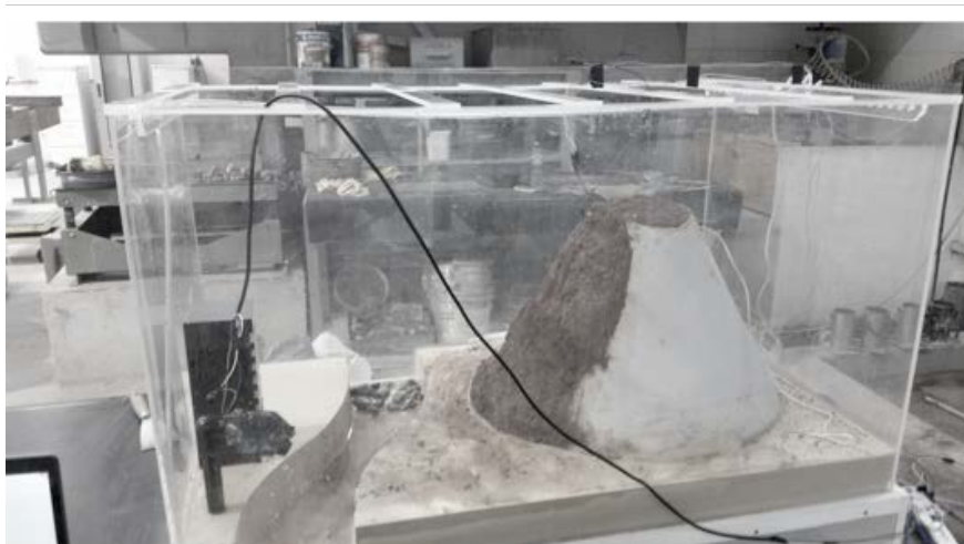
Figura 4. Imagem da maquete, com a mistura de solo aplicada e sensores posicionados
