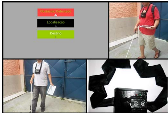
Figura 3. BlinGui sendo testado por PDV na Associação Baiana dos Cegos com detecção de obstáculos.
