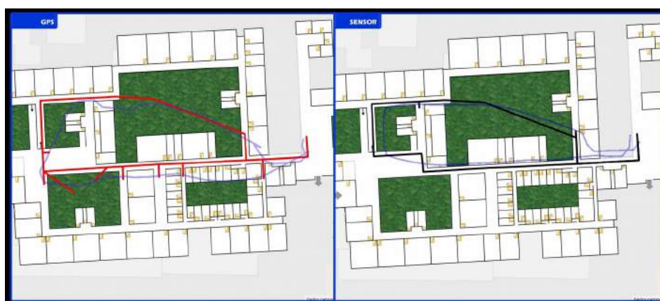
Figura 8. Rota 1 com a aplicação da correção de trajetória. À esquerda foi utilizado o sinal GPS para obter a posição. À direita foram usados os sensores de passo e magnetômetro.
