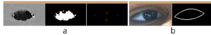
Figura 3. (a) Pontos obtidos com base no formato da imagem binarizada. (b) Resultado do uso da função Spline para formação do contorno dos olhos.
