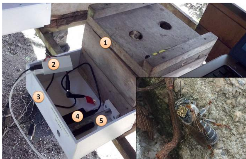
Figura 1. (1) Colmeia de Melipona Fasciculata , (2) Intel Edison para controle da antena leitora de RFID e armazenamento dos dados, (3) Caixa de PVC para armazenamento dos itens eletrônicos, (4) Antena leitora de RFID, (5) Tubo plástico para passagem das abelhas. No canto inferior direito, vê-se uma abelha com etiqueta de RFID presa junto ao tórax.
