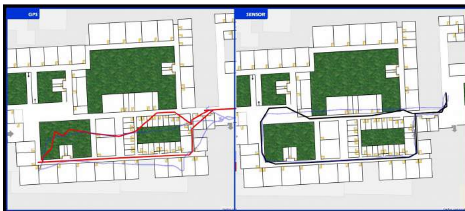
Figura 9. Rota 2 com a aplicação da correção de posição. À esquerda foi utilizado o sinal GPS para obter a posição. À direita foram usados os sensores de passo e magnetômetro.
