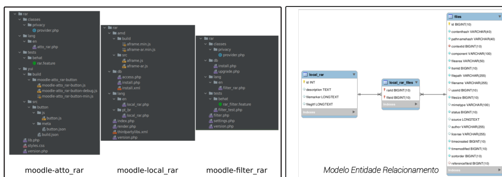
Figure 2. Estrutura do código fonte dos plugins: atto-rar, local-rar e filter-rar e modelo entidade relacionamento, implementado pelo plugin local-rar para os armazenamento de arquivos e marcadores
