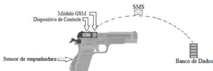
Figura 1. Ilustração do funcionamento do dispositivo. Imagem adaptada de Tecmundo.
