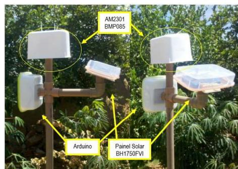
Figura 2: Foto da estação transmissora montada para o experimento (fonte: o autor)
