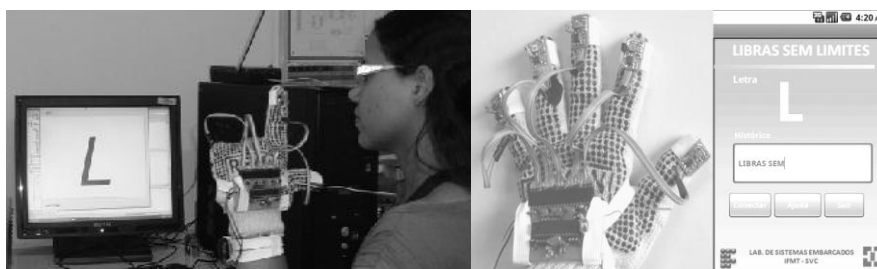
Figura 2. A esquerda a luva enviando os dados para um PC, no centro a luva e a direita a tela do aplicativo desenvolvido para receber as informações no dispositivo móvel.
