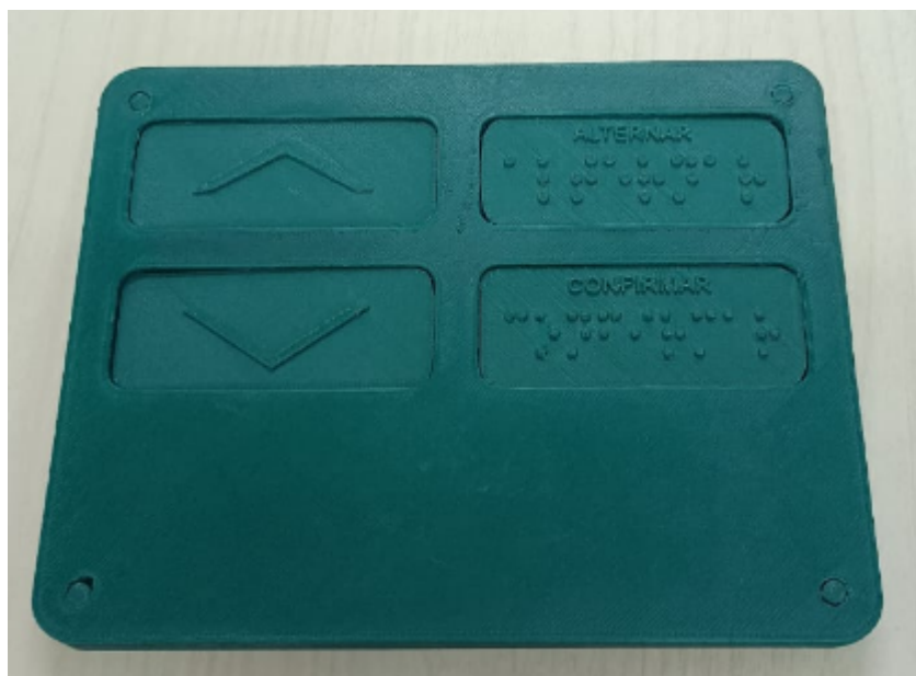
Figura 1. Teclado bluetooth. O microcontrolador é comportado em seu interior. Fonte: Autores.
