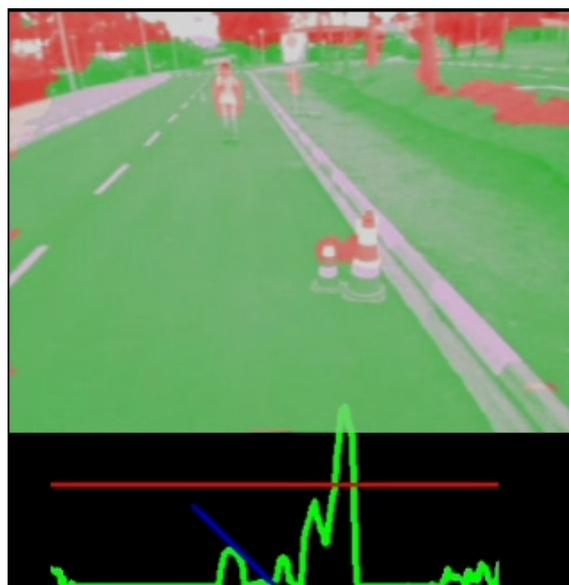
Figura 10. Mapa de navegabilidade gerado e ilustração do método de desvios de obstáculos utilizado.
