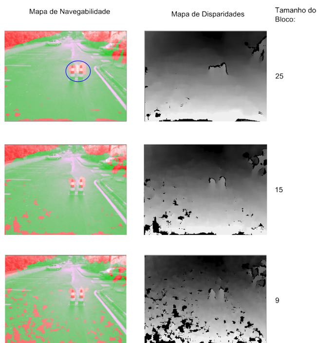
Figura 5. Comparação entre diferentes tamanhos de bloco utilizando o método local *block-matching*.
