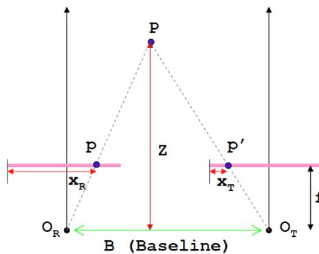
Figura 3. Sistema padrão (canônico) de uma câmera binocular com distância focal  $f$  e lentes deslocadas por uma distância  $B$  [Mattoccia 2009].
