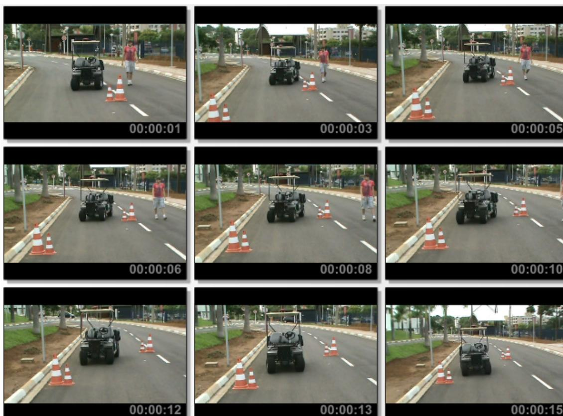
Figura 9. Carro elétrico desviando de cones de trânsito durante o experimento realizado.
