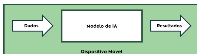
Figura 2. Esquema gráfico da abordagem com inferência no dispositivo móvel (On-device).
