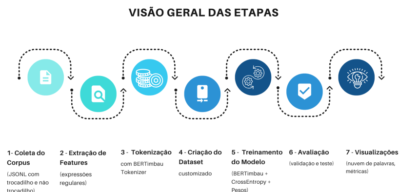
Figura 2. Visão geral das etapas do processo de classificação de trocadilhos utilizando BERTimbau.
