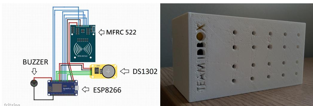
Figura 1. Esquema de circuito e modelo impresso da IDbox.
