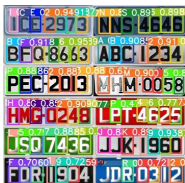
Figura 4: exemplo de teste de detecção da rede. Foram encontrados nesta imagem: 8 números-0; 6-1; 6-2; 5-3; 6-4; 3-5; 6-6; 2-7; 4-8; 3-9; 1-A; 2-B; 3-C; 2-D; 2-E; 2-F; 2-G; 3-H, 1-I, 3-J, 1-K, 3-M, 2-N, 1-O, 1-P, 2-R, 1-S, em 8.2ms. Fonte: Autores.
