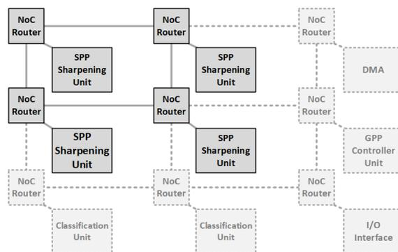
Figura 1. MPSoC com infraestrutura de aguçamento dedicada destacada
