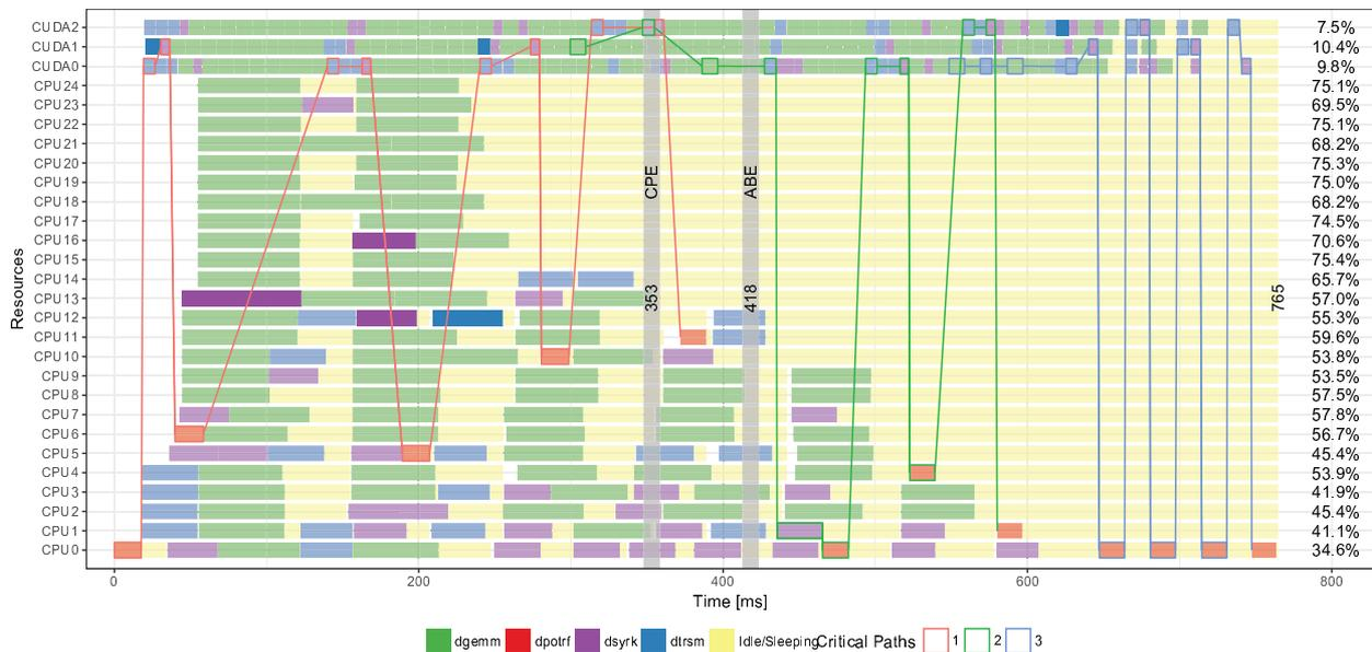
**Figura 1.** Representação visual da execução de uma fatoração de Cholesky ( $12 \times 12$  blocos de 960) em nó com 28 núcleos (2x Intel Xeon E5-2697v3) e 3 GPUs (NVIDIA Titan X). Execução com Chameleon+StarPU e escalonador DMDA.
