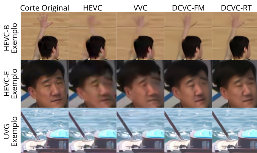
Figura 1. Comparação entre quadros decodificados, processados por cada codec à uma taxa de bits comparável.
