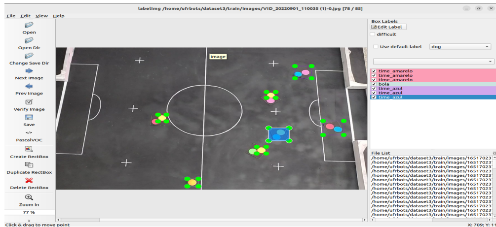
Figura 4: Processo de anotação de imagem no LabelImg.
