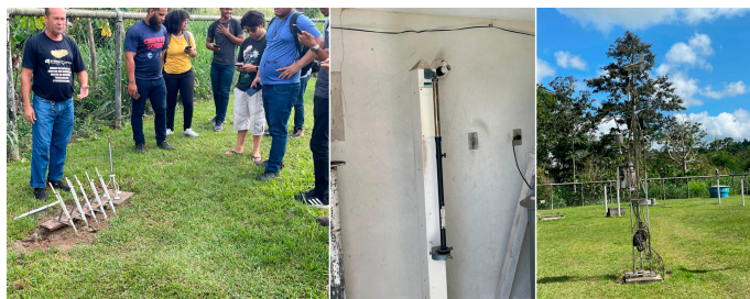
Figura 3. (a) Termômetros de mercúrio (b) barômetro analógico e (c) torre de 5 metros para medir velocidade e direção do vento.
