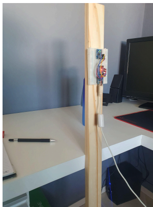
Figura 4. Dispositivo utilizado para simulação de pessoa caindo
