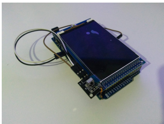
Figura 2. Protótipo em hardware inicial do Quizduino.
