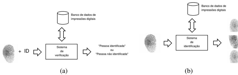
**Figura 1. Sistema de verificação (a) e identificação (b) de impressões digitais**
