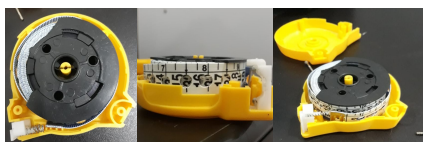
Figura 2 – Vista da fita perfurada dentro do corpo da trena.
