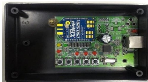
Figura 5 – Módulo XBee coordenador.
