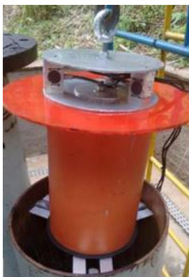
Figura 2: PIG de limpeza instrumentado para medidas de força.
