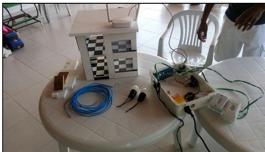
Figura 4. Cabos, jumpers , fios e fonte de alimentação para conexões elétrica e de rede
