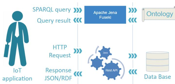
**Figura 1. Interação entre aplicação, ontologia e dados do dispositivo**
