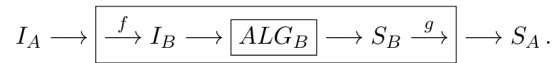
Figura 1. Fluxograma de ilustração de solução de um problema A por meio de redução para um problema B . Fonte: [Lintzmayer and Mota 2020].
