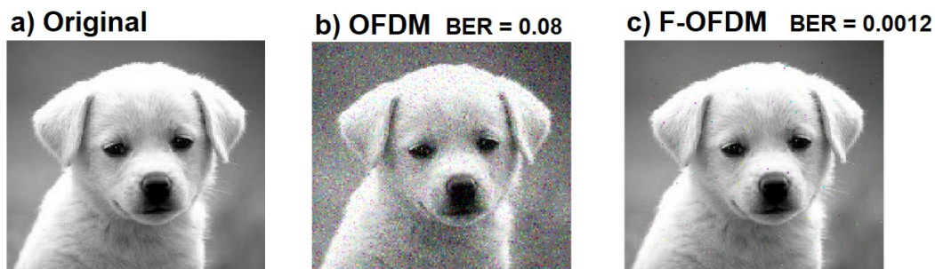
Figura 7. Processamento de imagem com F-OFDM
