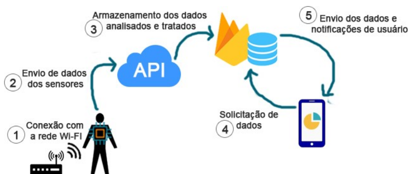
Figura 1. Figura ilustrativa da arquitetura do sistema de monitoramento proposto
