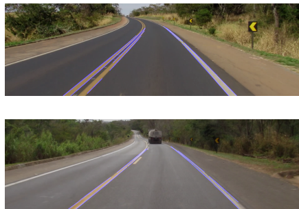
Figura 9. Detecção de retas com Transformada de Hough.
