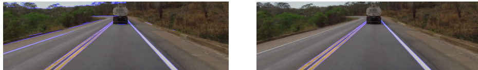
Figura 8. Detecção de retas com Transformada de Hough.
