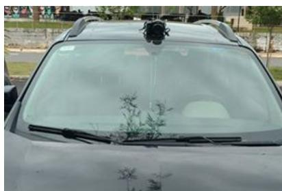
**Figura 3. Câmera acoplada no veículo para aquisição de imagem.**
