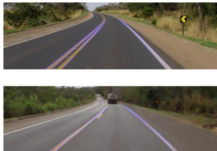
**Figura 9. Detecção de retas com Transformada de Hough.**
