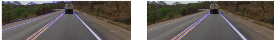
**Figura 8. Detecção de retas com Transformada de Hough.**
