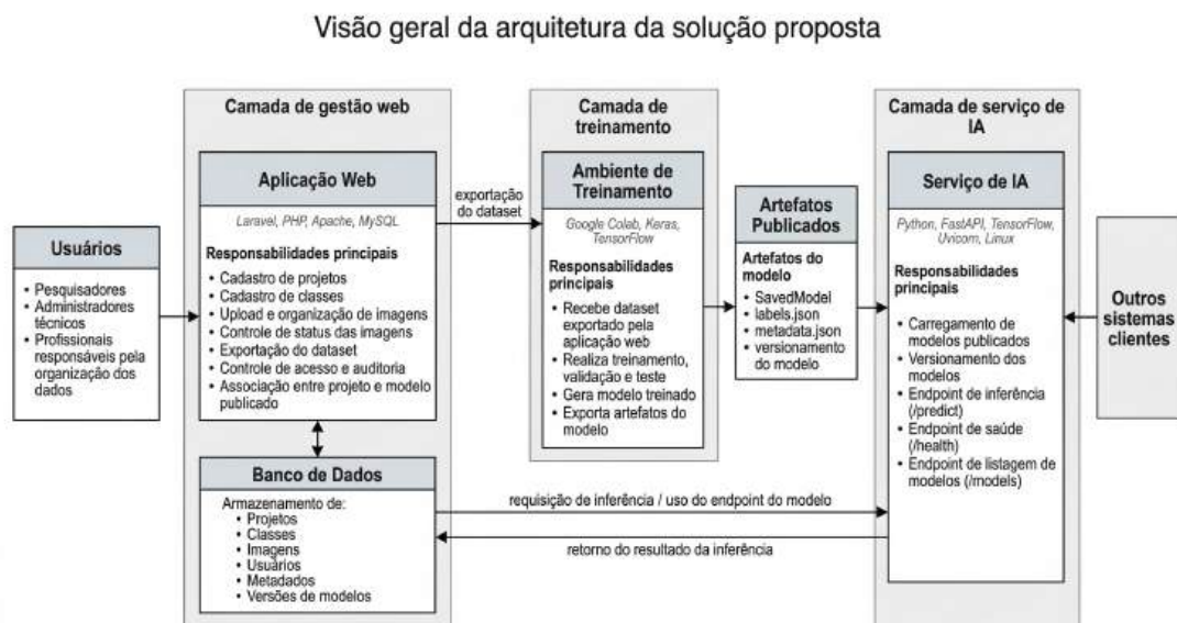
Figura 1. Arquitetura modular da solução proposta, com separação entre gestão web, treinamento e serviço de IA.
