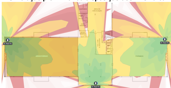
Figura 1. Simulação preliminar da disposição dos APs na banda 5 GHz
