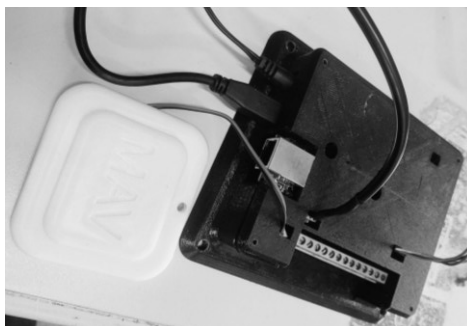
Figura 12 – Case da placa eletrônica feita em impressão 3D. Fonte: Autor
