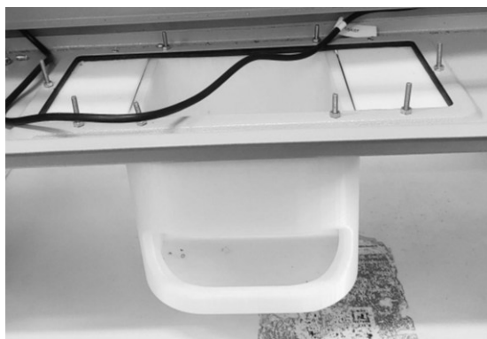
Figura 5 – Peça de Coleta dos absorventes. Fonte: Autor
