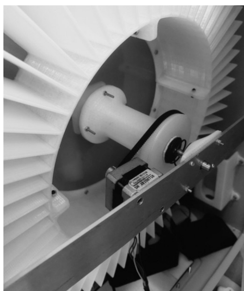
Figura 4 – Acoplamento do motor ao disco rotativo real. Fonte: Autor
