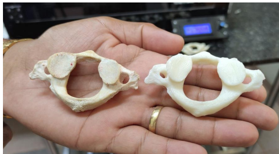
Figura 1. Peça original à esquerda e peça reproduzida com a impressão 3D à direita. Fonte: [ALENCAR 2024]
