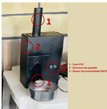
Figura 1. Protótipo do alimentador automático construído com caixa de papelão, cano PVC e componentes eletrônicos.
