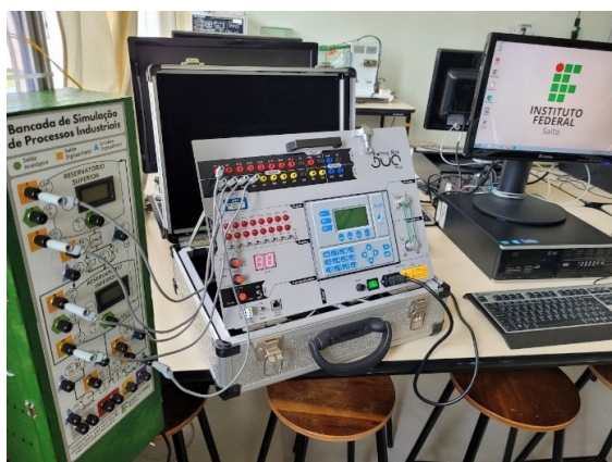
Figura 7. Integração da bancada didática com um sistema de CLP e registro das atividades de validação com os alunos.
