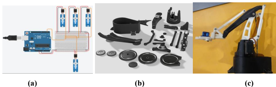
Figura 2. Fluxo de engenharia do Braço Robótico: (a) Simulação de circuito no Tinkercad; (b) Renderização paramétrica no Fusion 360; (c) Protótipo físico real finalizado em ABS.
