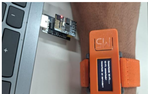
Figura 2. Comunicação da pulseira com o ESP-01 na etapa de coleta de dados.
