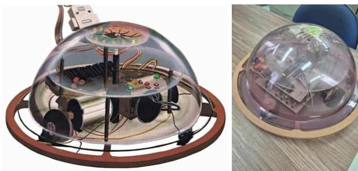
Figura 3. Tartaruga Tasman da Denning International (à esquerda) e versão construída no NIED/Unicamp (à direita).
