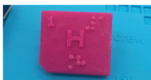
Figura 2. Keycap impressa em 3D integrada com o botão do protótipo.
