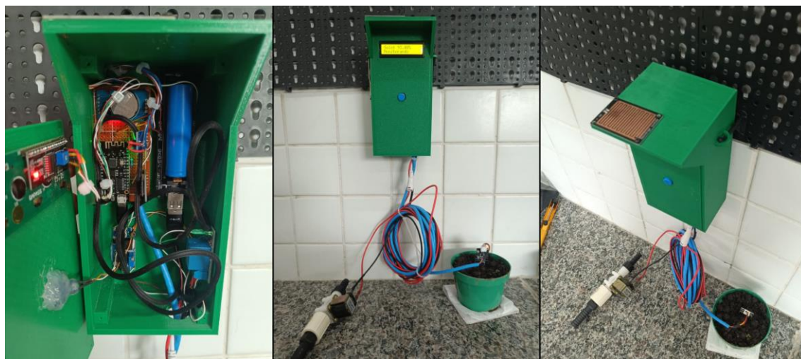
Figura 2. Protótipo do sensor de monitoramento e automação da irrigação
