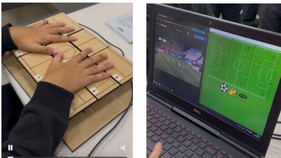
Figura 1. (a) Imagem da Maquete vibrotátil; (b) Imagem da Interface Gráfica
