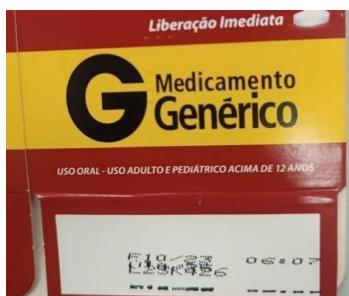
Fig. 3. Exemplo de carimbo com problemas de impressão (desvio).
