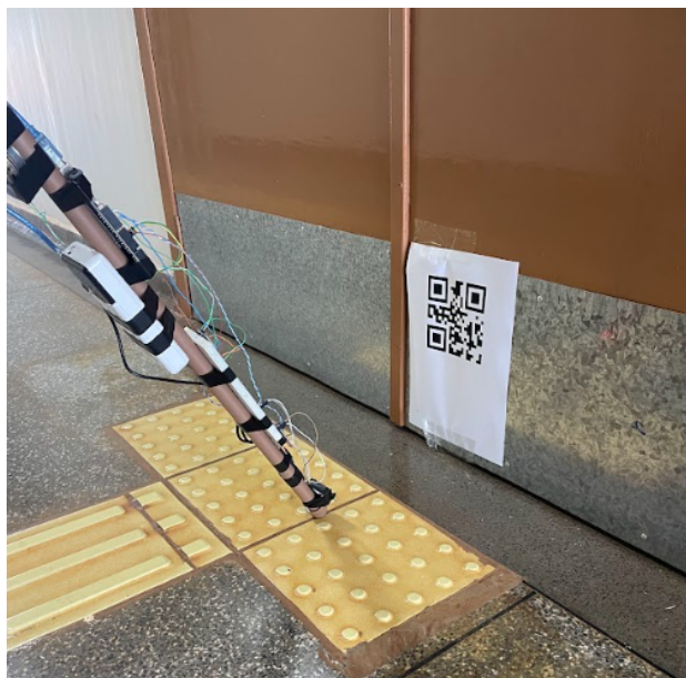
Fig. 5: Leitura do QrCode com correto alinhamento da câmera por meio do protótipo da bengala. Fonte: Do autor.
