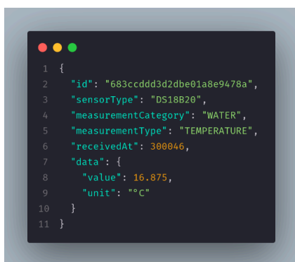
Fig 4 Estrutura do dado publicado em um tópico MQTT
