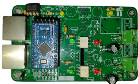
Fig. 5. Circuito confeccionado para sensado y envío del estado de las máquinas.
