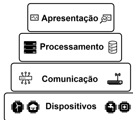
Figura 1. Arquitetura básica de uma aplicação de IoT.
