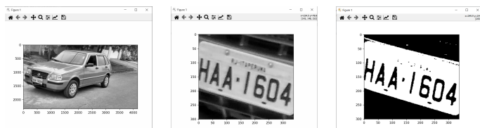
Fig. 3. Etapas de processamento da imagem: captura, recorte da placa e segmentação dos caracteres para carros.
