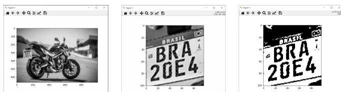
Fig. 4. Etapas de processamento da imagem: captura, recorte da placa e segmentação dos caracteres para motos.
